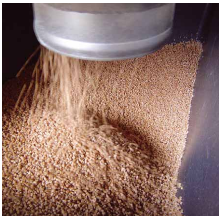
Granulierung von Arbofill®. Bild: Tecnaro
