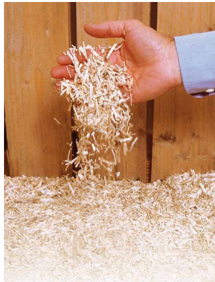
Unbehandelte Hanfschäben bilden die Leichtfraktion des neuen Baustoffes.
