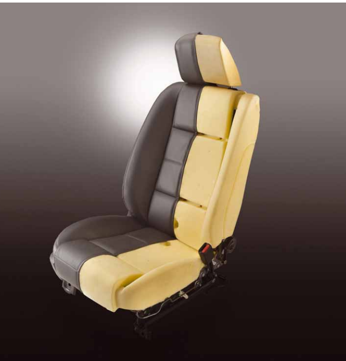
Automobilbauer nutzen zunehmend Biowerkstoffe. So stellt Ford Armaturenbretter als Kenaf-Polypropylen-Verbund her. Schaumstoffe auf Sojabasis werden für den Autositz im Ford Mustang eingesetzt. Bilder: Ford
