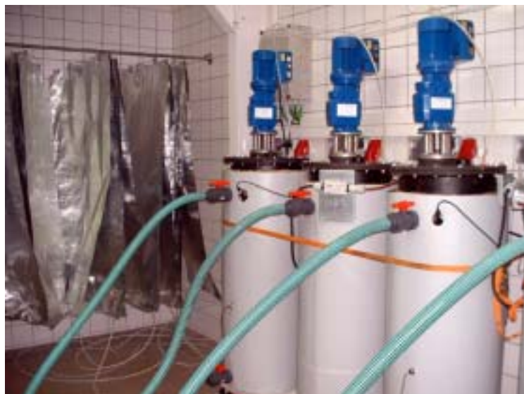
Abbildung 9: Bioreaktoren zur Durchführung von kontinuierlichen Versuchen zum anaeroben Abbau von Biomasse (Nutzvolumen: 120 l, T = 37 °C)
