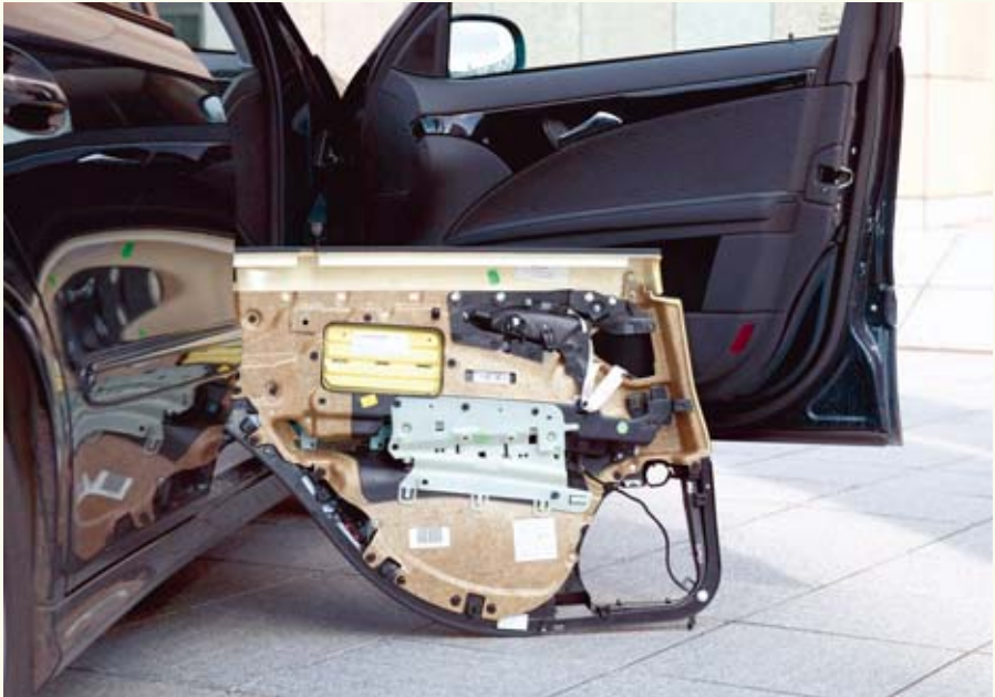
Abb. 27: Tür-Innenverkleidung beim PKW (Quelle: R+S Technik GmbH)
