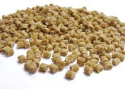
Abb. 22: Spritzgießgranulat aus Naturfasern, Polypropylen und Haftvermittlern
