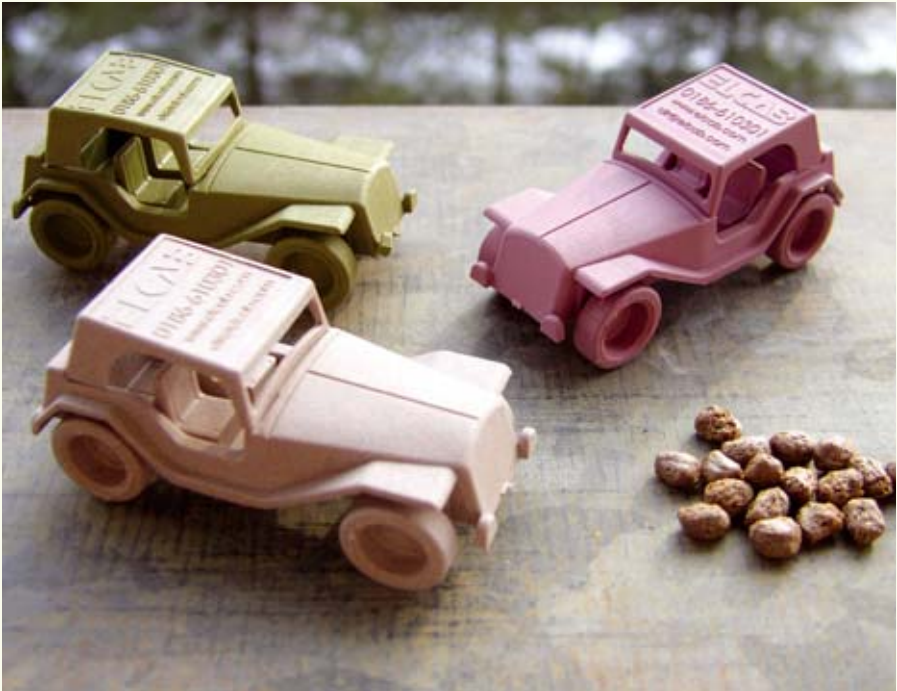
Abb. 4: Naturfaserverstärkte Kunststoffe machen Autos leichter und umweltfreundlicher (Spielzeugautos aus Naturfaser-Polypropylen-Spritzguss) (Quelle: GreenGran B.V.)
