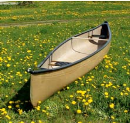
Abb. 28: Kanu aus Naturfaserverstärkten Kunststoffen (handlaminiert) (Quelle: FNR)
