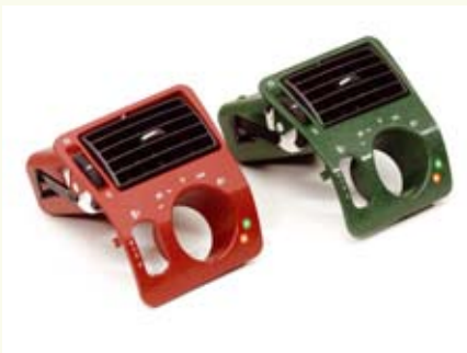
Abb. 26: Lüftungsgehäuse aus WPC, Entwicklung für den PKW (Quelle: Werzalit GmbH & Co. KG)
