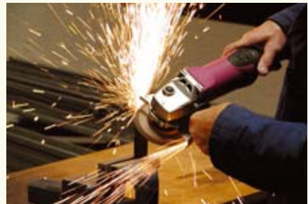
Abb. 23: Fächerschleifscheibe mit Hanf-PP-Träger im Einsatz (Quelle: Gerd Eisenblätter GmbH)
