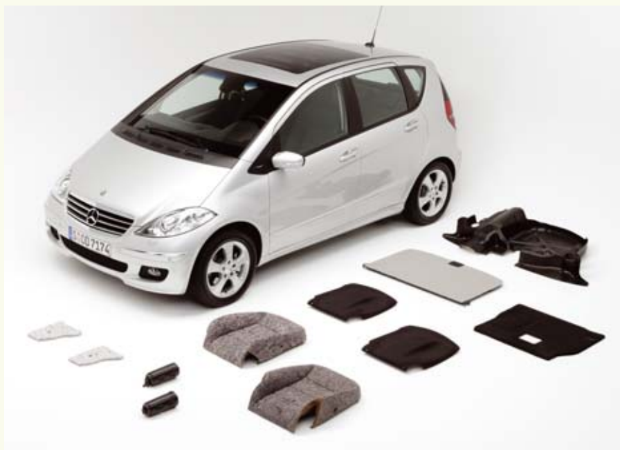
Abb. 6: Pkw mit Formpressteilen (Quelle: Daimler AG)
