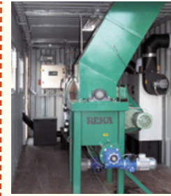
Ein Blick in die Anlage: Cutter, der spezielle Edelstahlfilter und der Brennraum.
