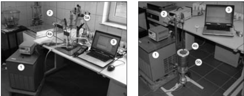
Abb. 9: Labor-Versuchsaufbau, links mit MW-Nadelsensor und rechts mit Patchantenne, 1 Thermostat, 2 Rührer, 3 Mess-PC, 4a beheiztes Probengefäß (Glasdoppelmantel), 4b beheiztes Probengefäß (Kunststoffrohr mit Schlauchheizung), 5a MW-Sensor mit Nadelantenne, 5b MW-Sensor mit Patchantenne
