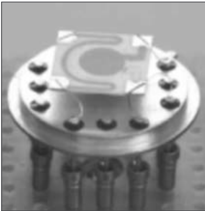
Abb. 2: Sensorchip eines H_2 -Festelektrolytsensors
