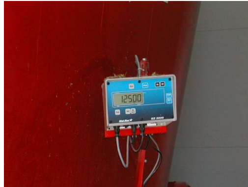
Abbildung 29: Adaptierter Futtermischwagen mit Wiegezellen
