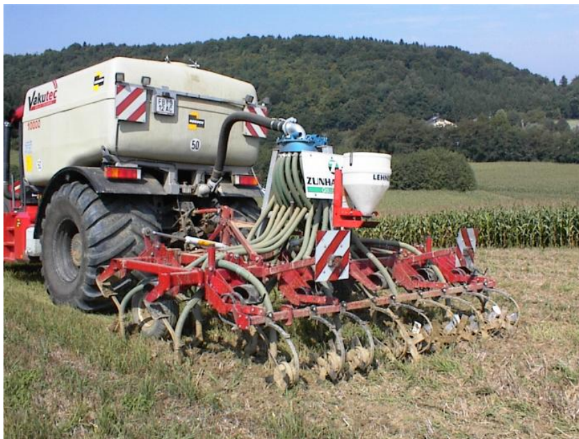
Abbildung 48: Selbstfahrer mit angehängtem Güllegrubber (Quelle www.walch.or.at )
