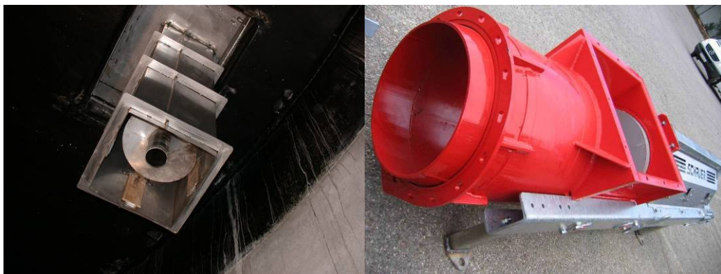
Abbildung 28: Stopfschnecke im Fermenter und Eintragskolben (rechtes Foto: Firma Schauer Maschinenfabrik GesmbH & Co KG)
