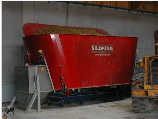
Abbildung 29: Adaptierter Futtermischwagen mit Wiegezellen
