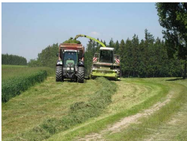
Abbildung 9: Feldhäcksler mit 354 kW Nennleistung bei der Anwelkgutaufnahme mit 3-m-Pick-up
