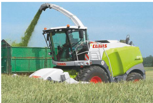
Abbildung 10: Getreideganzpflanzenernte mit Direktschneidwerk (Werksfoto Firma Claas)
