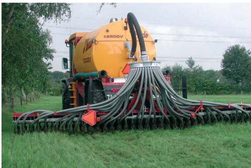
Abbildung 49: Selbstfahrer mit Scheibeninjektor im Grünland-einsatz mit versetzter Spur (Quelle Firma Vredo)
