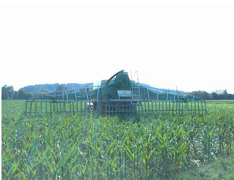
Abbildung 47: Gärrestausbringung mittels Schleppschlauchverteiler im bestehenden Maisbestand mittels Selbstfahrer (Quelle www.walch.or.at )
