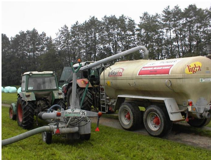
Abbildung 45: Fahrbare Pumpe zur schlagkräftigen Fremdbefüllung (Quelle www.walch.or.at )
