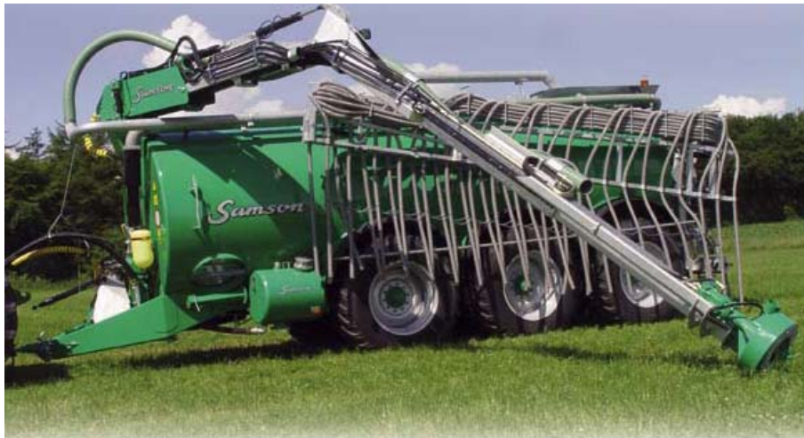
Abbildung 43: Vollhydraulischer Pumpenturm (Quelle Samson Agro A/S)
