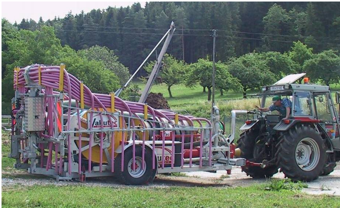
Abbildung 53: Verschlauchungsanlage am Transportanhänger (Quelle Vakutec)
