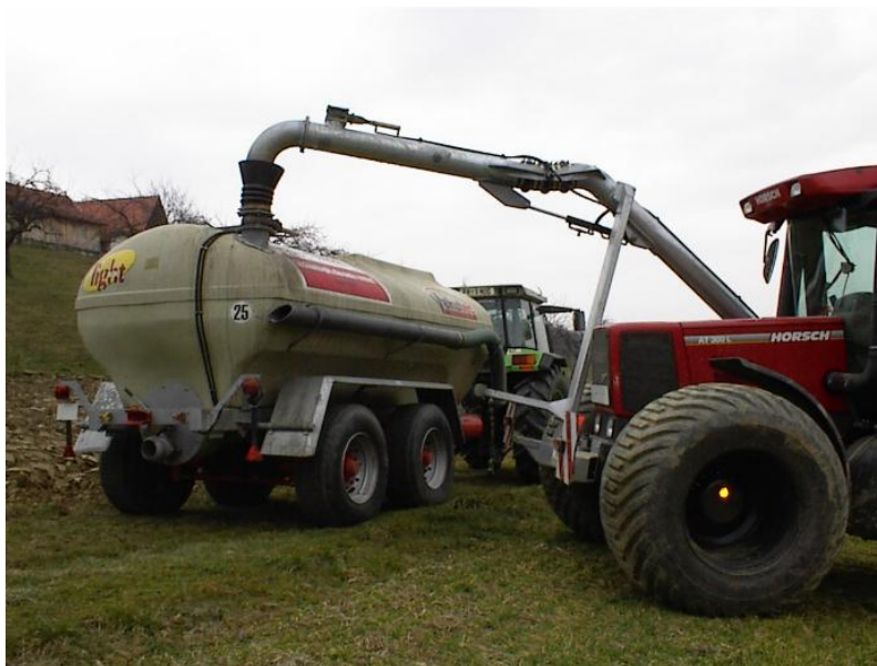
Abbildung 46: Gärrestübernahme mittels Saugarm vom Zubringfass (Quelle www.walch.or.at )
