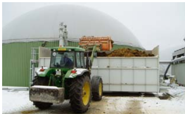
Abb. 51: Feststoffdosierer für die Bevorratung und für den Transport der Silage in den Fermenter
