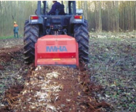
Abb. 11: Wurzelbeseitigung mit Forstfräse
