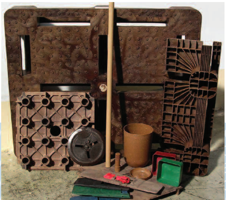
Im Spritzgießverfahren lassen sich heutige Kunststoffprodukte durch naturfaserverstärkte Kunststoffe austauschen.
