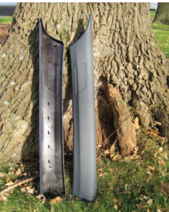
Türverkleidungen (Doortrim) aus Biokunststoffen zielen auf die Automobilbranche.
