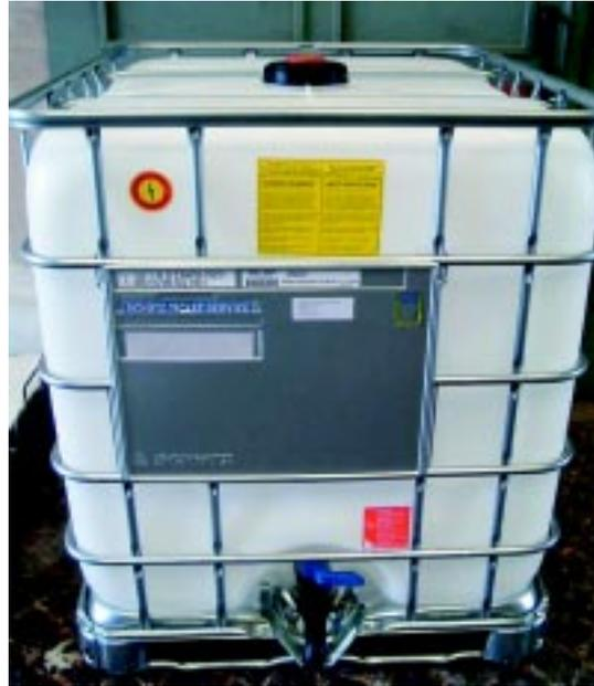
Typisches Prüfmuster (RIBC mit Kunststoffblase) zur Prüfung elektrostatischer Aufladungen
