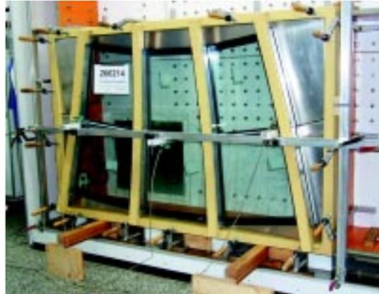
*Prüfung eines Teilelementes einer Glaskuppel-Konstruktion auf Luftdurchlässigkeit, Schlagregendichtheit und Widerstandsfähigkeit bei Windlast
