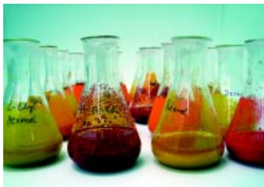
Herstellung von Kalibriersubstanzen für die flüssigchromatographische Bestimmung von Aldehyden
