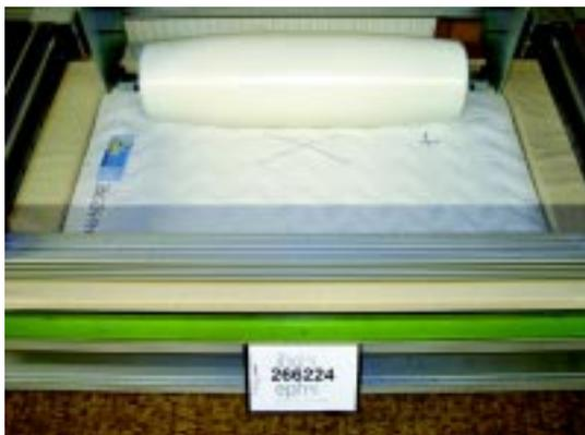
Simulation der Nutzung einer Matratze mittels Dauerhaltbarkeitsprüfung (so genannte Walzenprüfung)
