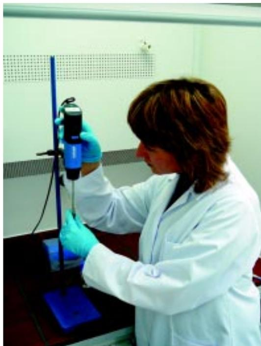
*Aufschluss einer Praxisprobe für DNA-Extraktion mittels Mikrostill*
