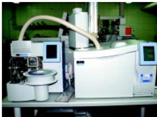
Erweiterung der Ausrüstung im gaschromatographischen Labor zur Bestimmung von VOC und Holzschutzmittelwirkstoffen
