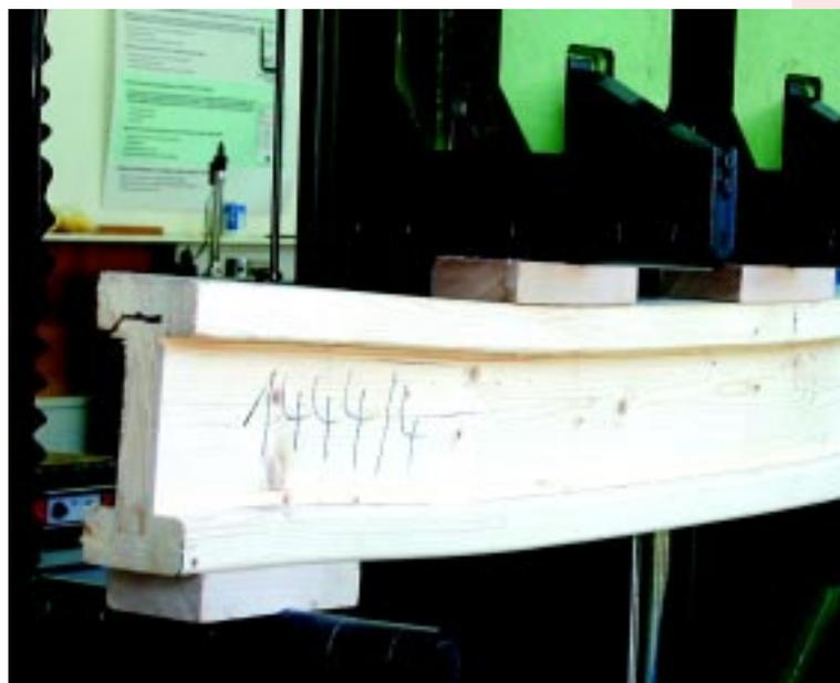
Prüfung eines Schalungsträgers zur Schnittkräftebestimmung
