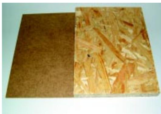
*Industrieplatten mit pPF-Harz-Bindung, links HDF, rechts OSB*
