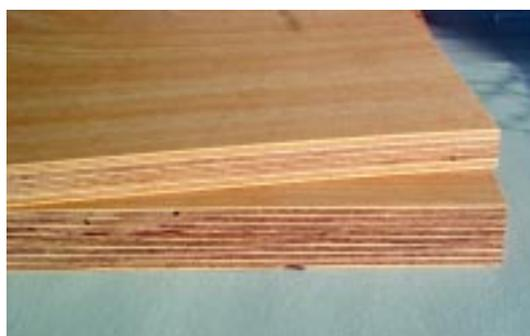
*Industriesperrholzplatten in BFU100-Qualität, oben pPF-Harz-Bindung (helle Leimfuge), unten PF-Harz-Bindung (dunkle Leimfuge)*
