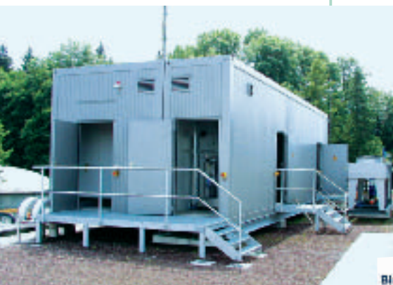
Abbildung 4: Biogasaufbereitungsanlage in Containerbauform
