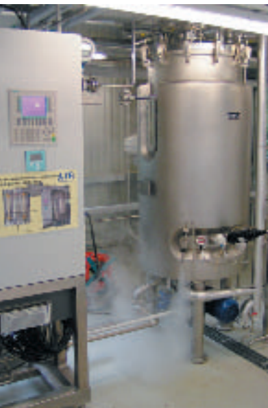
Abbildung 2: 450 Liter Fermenter für die kontinuierliche Milchsäurefermentation
