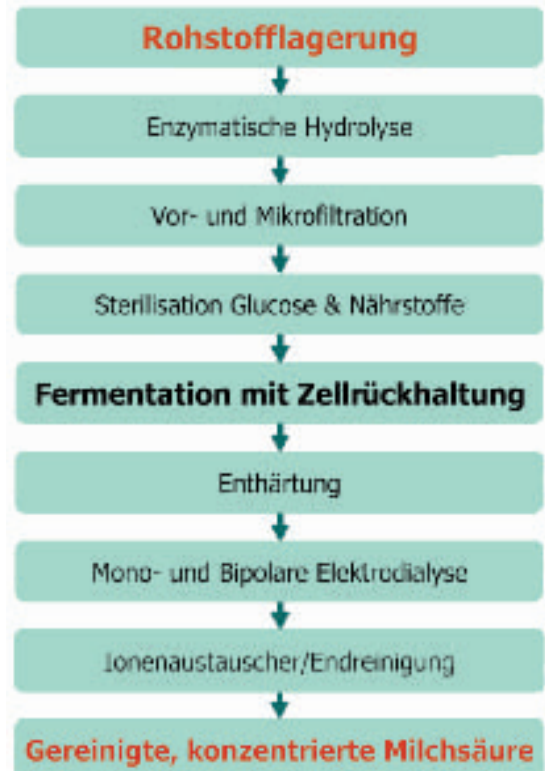
Abbildung 1: Prozessschema zur Herstellung von Milchsäure
