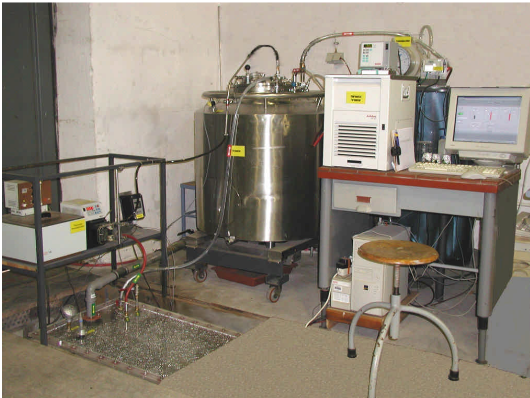
Abbildung 8: Ansicht des Versuchsstandes „Festbettfermenter mit Perkolation“
