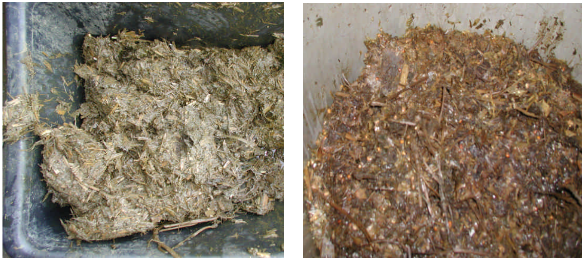
Abbildung 13: Gärrest vor der aeroben Nachbehandlung (links) und nach 14 d Intensivrotte (rechts)
