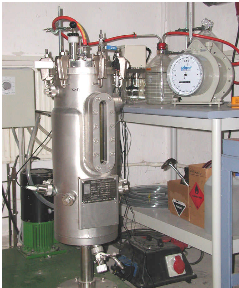
Abbildung 1: Gesamtansicht des Versuchsstandes „Rührkesselfermenter“
