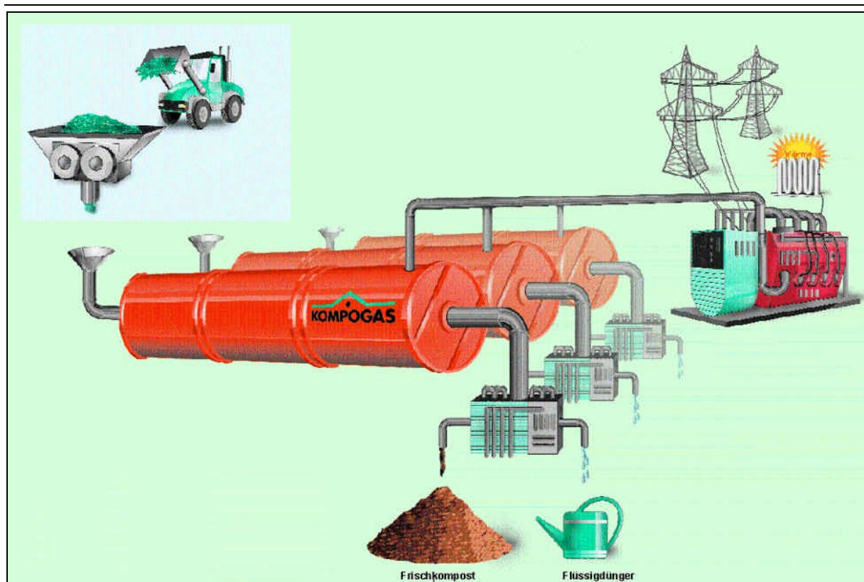
Abbildung 15: Verfahrenschema Pfropfenstromfermenter [KOMPOGAS]
