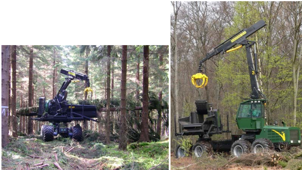
Abb.: 79 Multifunktionsmaschine beim Bündeln (Foto: Wagner 2006)
