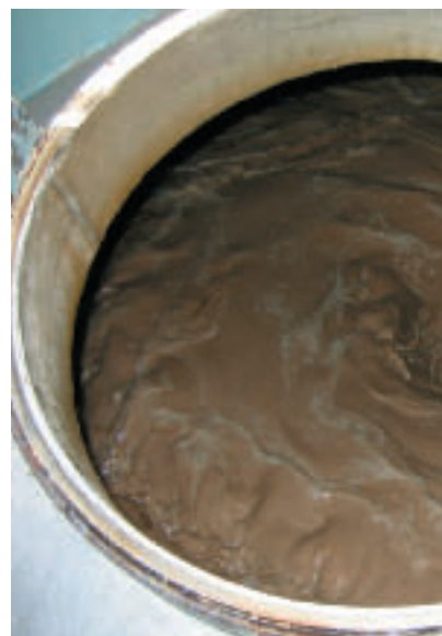
Blick in einen Vormaischbottich mit Rührwerk
