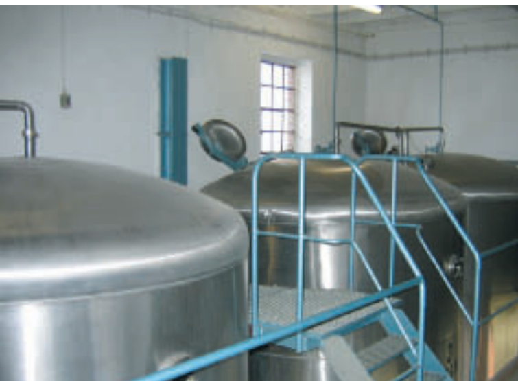
Maischbottiche in einer westfälischen Brennerei. In den Edelstahlbehältern wird Stärke durch Enzyme in vergärbare Einfachzucker gespalten (Foto: Sprenker)
