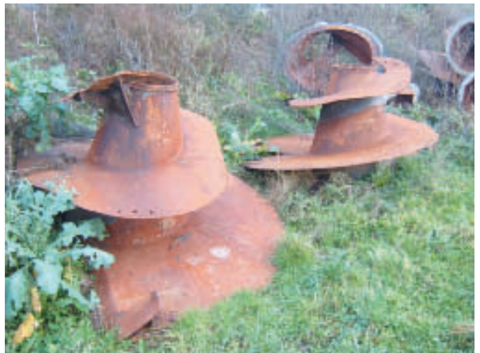
Nach nur drei Jahren Betriebszeit sind die Transportschnecken völlig verschlissen
