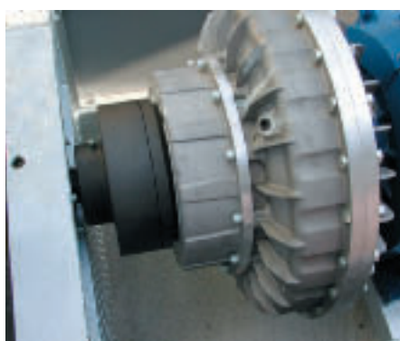
Die Flüssigkeitskupplung schließt erst bei Nenndrehzahl (Foto: Pfrengle)
