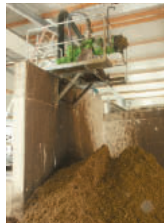
Hier wird das Gärprodukt in feste und flüssige Phase getrennt (Foto: fnp)
