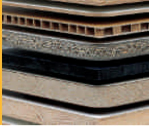
Die Vorteile von Holzwerkstoffen liegen in ihrer Homogenität und Stabilität. Zudem lassen sich platten- und stabförmige Elemente herstellen, deren Abmessungen mit Vollholz nicht erreicht werden können.
