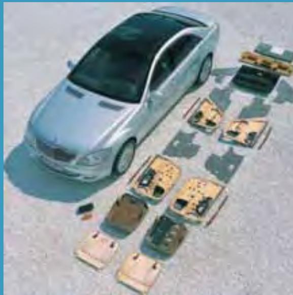
Neue DaimlerChrysler S-Klasse: Einsatz von Bauteilen aus NR massiv gesteigert
