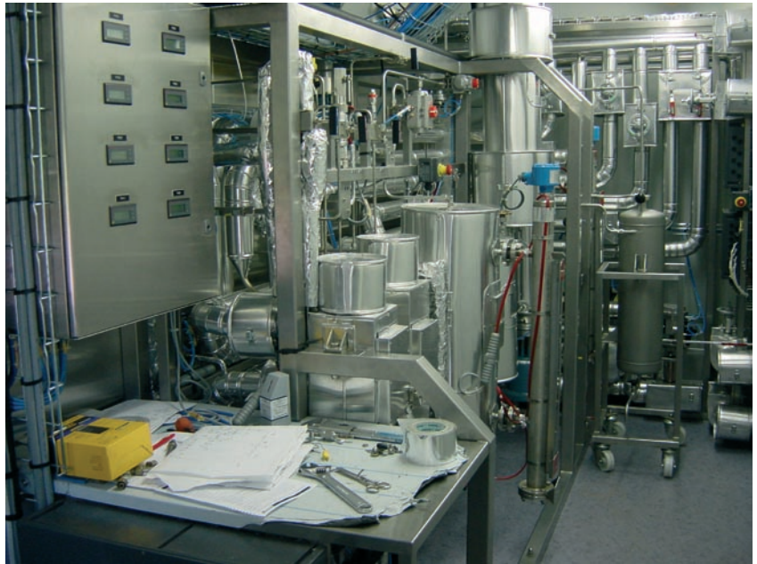
Abb. 6: Die Harrod-Research, Schweden, hat „das Zweifach-Prinzip“ in die Praxis überführt. Bochumer Forscher haben die Versuchsanlage zuvor verfahrenstechnisch ausgelegt. Derzeit liefert die Versuchsanlage zur Hydrierung 5 - 8 kg Fettalkohole.
