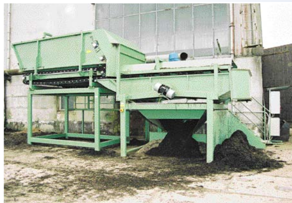
Die Entsandungsanlage zur Trennung der Fremdstoffe The de-sanding facility used to remove foreign matter
