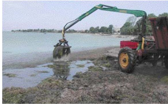
Verladung von Seegrass auf der Insel Møn (DK) mit einem Kran auf einem Container
