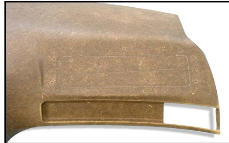
Vorderseite: Sichtbare Schwächungslinien
