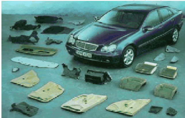
Bauteile aus naturfaserverstärkten Kunststoffen (Quelle: Daimler Chrysler)
