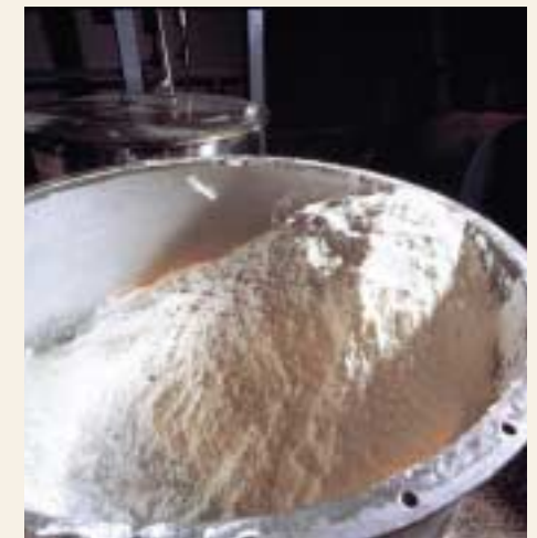
Granulat aus destrukturierter und komplexierter Stärke und abbaubaren Polymeren natürlicher Herkunft
